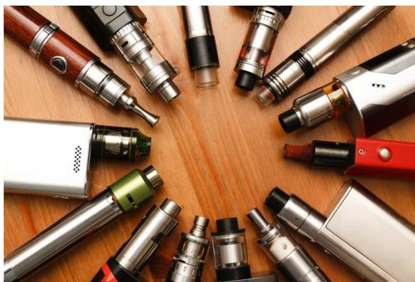
Принцип работы электронной сигареты: от батареи подается электрический импульс, спираль нагревается, а жидкость, которая состоит из пропиленгликоля, глицерина, никотина и ароматизаторов, превращается в пар.
